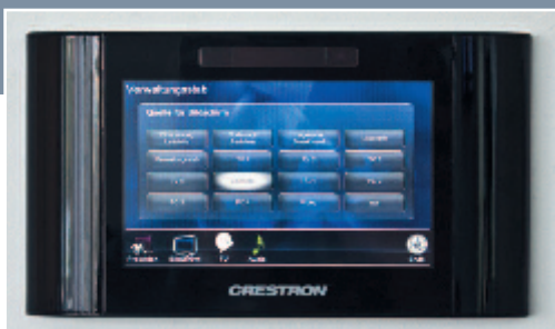
Crestron Touchpanel mit individuell programmierter Benutzeroberfläche
